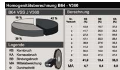
Bild 11 Homogenitätsberechnung B64 - V360
