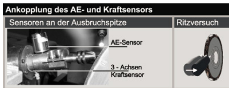
Bild 2 Ankopplung des AE- und Kraftsensors
