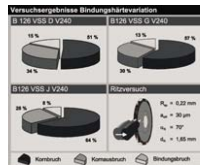
Bild 7 Versuchsergebnisse Bindungshärtevariation (Ritzversuch)
