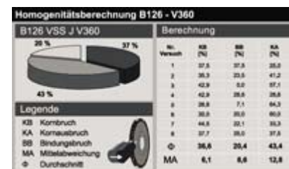
Bild 12 Homogenitätsberechnung B126 - V360
