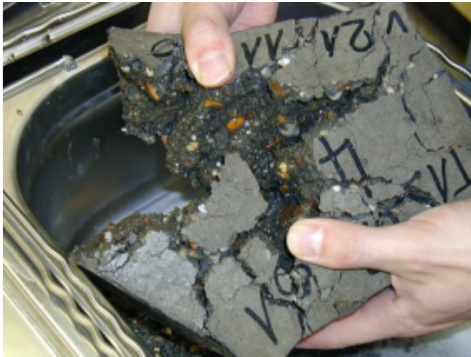
Bild 7: CIF-Platte (w/z)_{eq} 0,45 mit 8 M.-% Silicastaub nach 56 Frost-Tauwechseln
